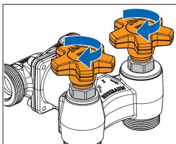
1. S'assurer que le robinet de dérivation et le robinet d'arrêt sont fermés dans le sens des aiguilles d'une montre, **jusqu'à la butée**.
