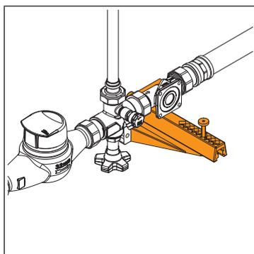
2. La console 19092.06 est fixée au mur pour que la bride en Y puisse s'y appuyer.
