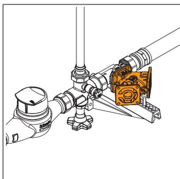
3. Monter la bride en Y 19191 contre le boîtier de raccordement 12085. Observer la procédure correcte pour tous les assemblages par bride (☞ «Assemblage des raccords à brides», page 3).
