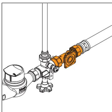
1. Monter le boîtier de raccordement 12085 au niveau de la distribution principale.
