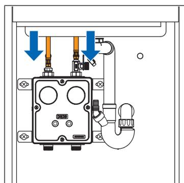
5. Raccorder les tuyaux renforcés du mitigeur de cuisine et le tuyau à eau du lave-vaisselle. Pour ce faire, on peut tourner le té du raccord de lave-vaisselle dans toutes les directions par incréments de 45°.
