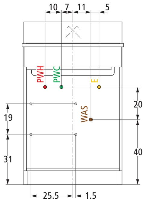
Fig. 1: Dimensions du montage de la garniture de raccordement de cuisine 70090 et 70091
