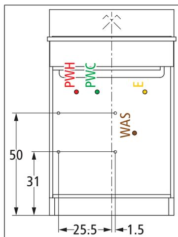
1. Marquer les 4 points de fixation sur le mur et réaliser les perçages. Se rappeler que la taille des perçages est fonction du type de vis à utiliser, et que les distances entre les points de fixation sont différentes pour les garnitures de raccordement de cuisine 70090 et 70091.
