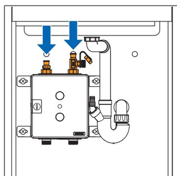
3. Monter l'accouplement rapide fourni ou le té avec le raccordement pour lave-vaisselle 70132 et effectuer un essai d'étanchéité.
