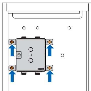
2. Attacher la garniture de raccordement de cuisine au mur avec les 4 vis adéquates.
