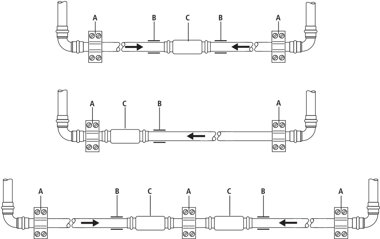
Fig. 1: Exemples de montage d'un compensateur axial
