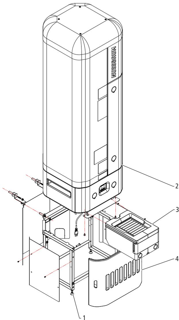
Fig. 1: 68030 Chauffe-eau pompe à chaleur Aquapro-Ecotherma, installation libre
