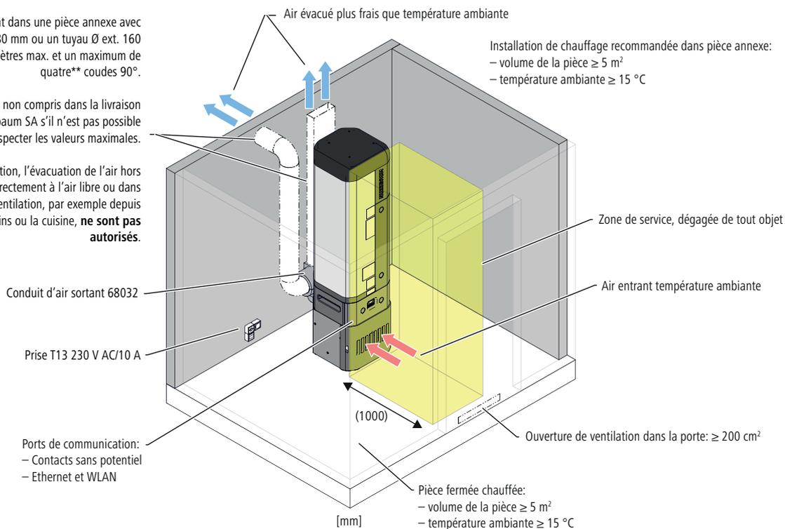
Fig. 3: Conditions de pose pour l'installation de l'appareil dans des petits locaux
