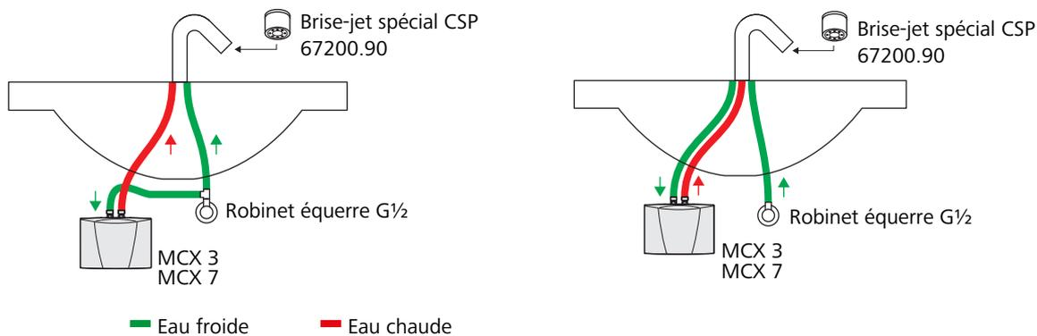
Fig. 1: Exemple de montage pour un montage sous lavabo
