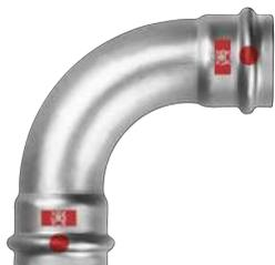
I pressfitting in acciaio zincato sono realizzati in acciaio non legato con il codice materiale 1.0308 (E235). I pressfitting sono zincati elettroliticamente sulla superficie interna ed esterna. Sono contrassegnati con il logo «acqua non potabile»:
