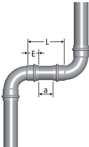
Fig. 5: Lunghezza minima del tubo fra due pressature.
