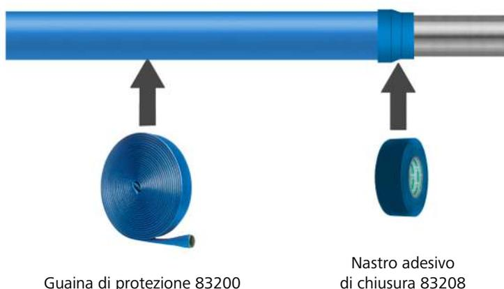
Le estremità devono essere sigillate in modo da impedire l'infiltrazione di acqua sotto il rivestimento, ad esempio utilizzando il nastro adesivo di chiusura 83208.
