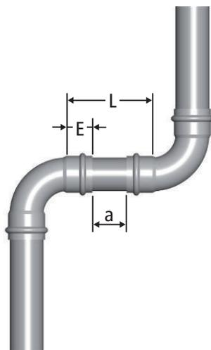
Fig. 5: Longueur minimale du tuyau entre deux sertissages
