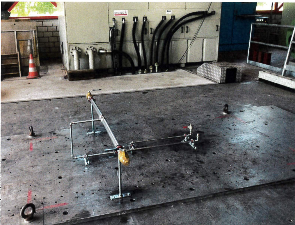
Abbildung 2: Prüfrichtung Z-Achse (10 t Vertikal-Schockprüfmaschine VESPA)
