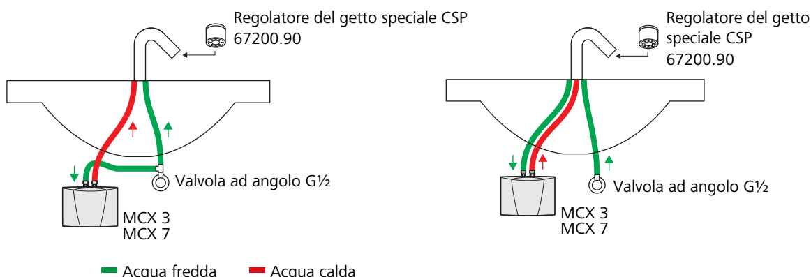
Fig. 25: Approvvigionamento singolo con gli scaldacqua istantanei per lavabo MCX 3 / MCX 7
