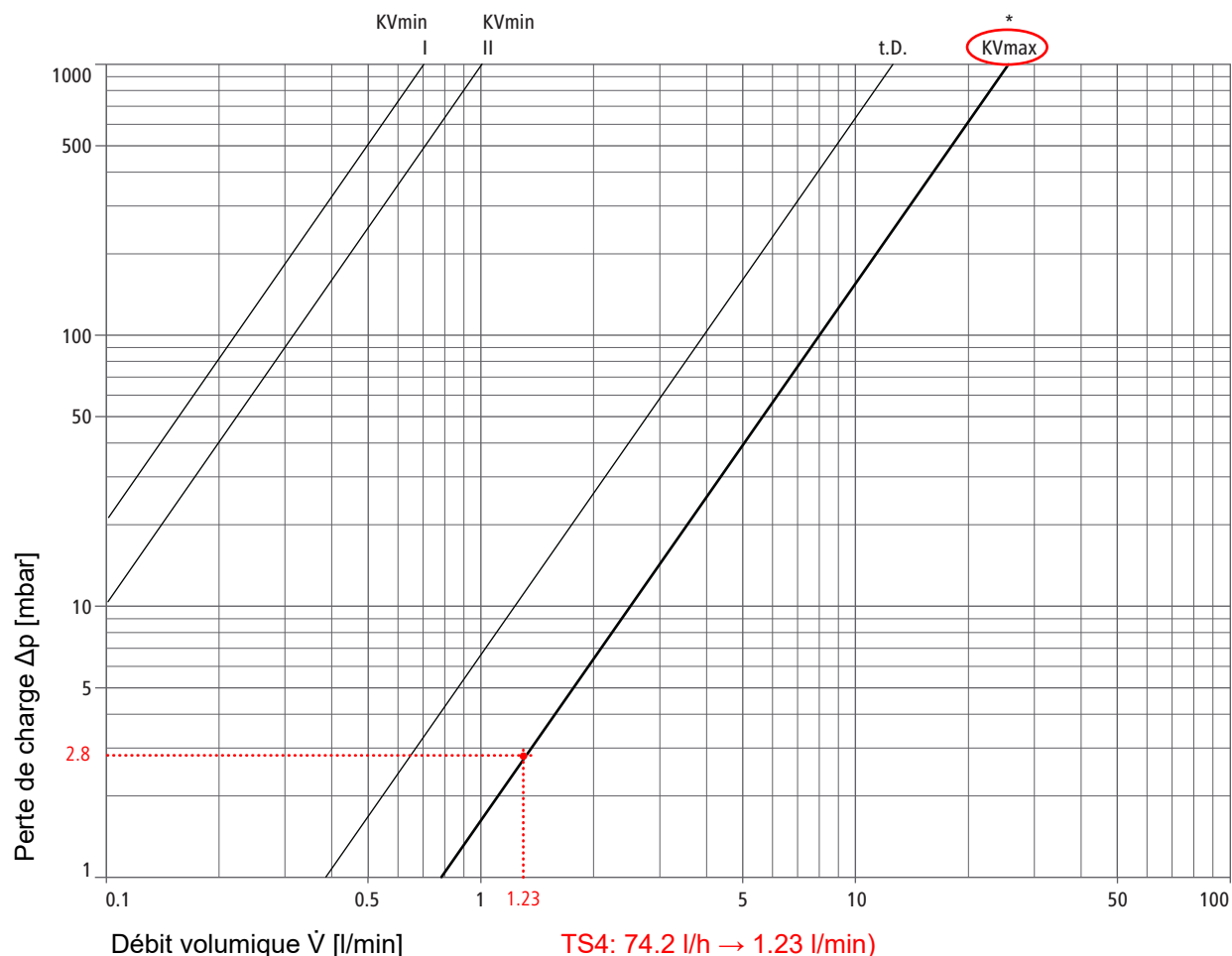
Fig. 41: Exemple de lecture pour le diagramme de performance du régulateur de circulation 36010
