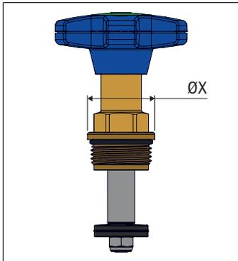
2. Den Richtwert berechnen: Gemessener Durchmesser  $\varnothing X - 10$  mm.
