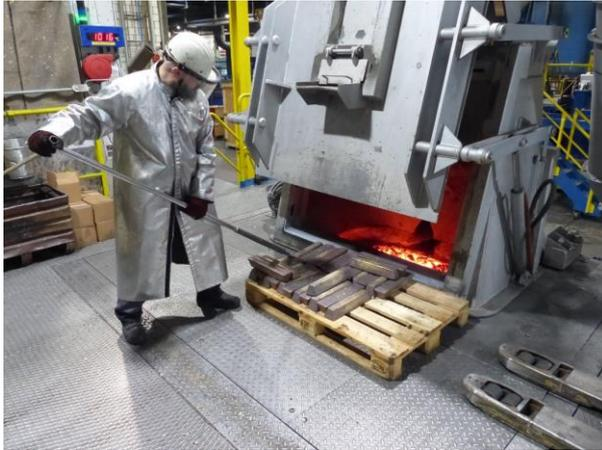
*Illustration 1: Ce nouvel alliage de bronze est introduit sous forme de lingots dans le four de fusion. Le four de coulée peut ensuite être rechargé avec le métal en fusion.*
