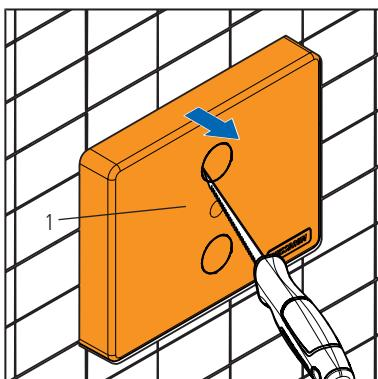
10. Une fois le mur carrelé, appuyer sur les trous préponçonnés à l'aide d'un couteau pour les ouvrir.
