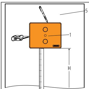
7. Retirer le couvercle de protection (1) et ajuster le boîtier robinetterie suivant la hauteur (H) mesurée antérieurement sur la plaque de plâtre (5) et en faire un tracé au crayon.
