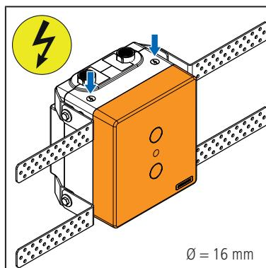
6. Si une interrogation à distance (système bus) est prévue, percer les trous (16 mm) pour les raccordements électriques au niveau des symboles de foudre. Préparer les tubes vides pour câbles.
