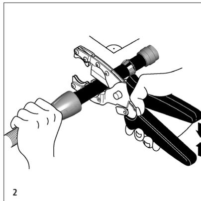
Rohr mit Spezialschere (87092 oder 87094) hinter dem Klemmring kürzen.
