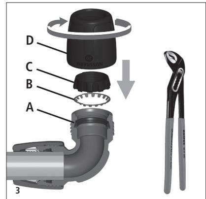
Formdichtung (A) kontrollieren und bei Beschädigung Fitting ersetzen!
