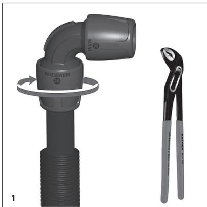
Schraubkappe mit Zange im Gegenuhrzeigersinn abschrauben.
