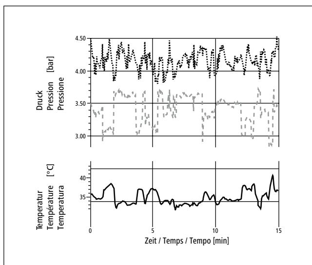
Das Diagramm veranschaulicht die nicht gleichverlaufenden Druckveränderungen zweier separater Druckreduzierventile bei unterschiedlichem Kalt- und Warmwasserbezug.
