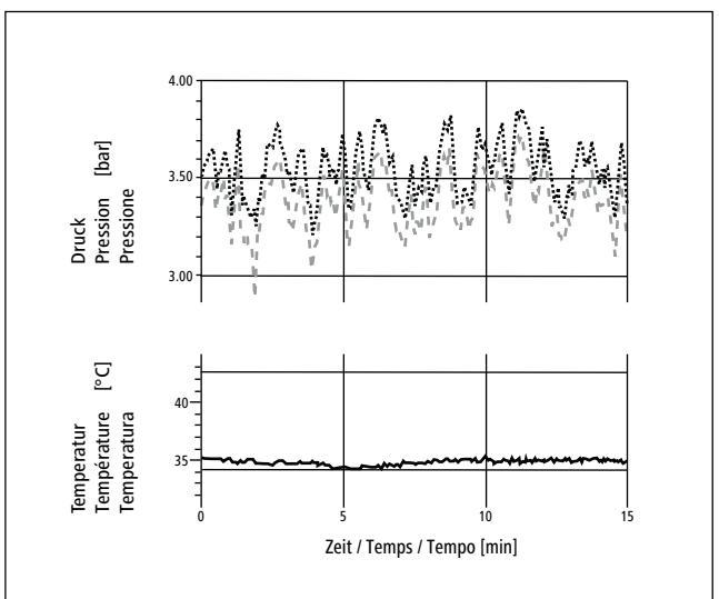
Dieses Diagramm zeigt, dass mit einem zentralen Druckreduzierventil zwar Druckschwankungen vorhanden sind, diese aber im Kalt- sowie Warmwassersystem zeitgleich und parallel verlaufen.
