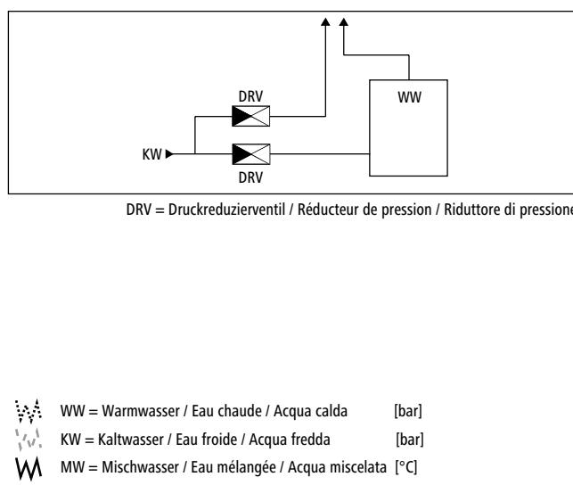
Le diagramme démontre les évolutions de pression de deux réducteurs séparés dans le cas d'une consommation simultanée d'eau froide et d'eau chaude.
