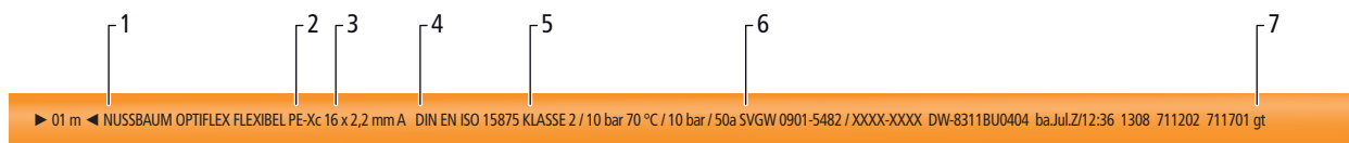
Fig. 2: Marquage du tuyau Optiflex PE-Xc souple
