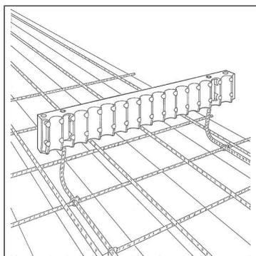
1. Fissare il supporto multiplo per tubi Optiflex 87058 alla cassaforma utilizzando delle fascette.
