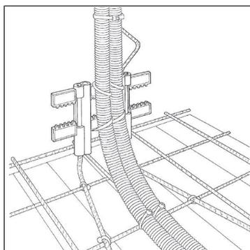
2. Fissare i tubi Optiflex con le fascette al supporto per tubi e alla cassaforma.
