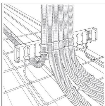
2. Fissare i tubi Optiflex con le fascette al supporto multiplo per tubi Optiflex e alla cassaforma.
