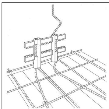
1. Fissare il supporto per tubi Optiflex 87069 alla cassaforma utilizzando delle fascette.
