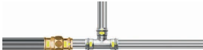
Rénovation à partir d'une installation existante en acier galvanisé
