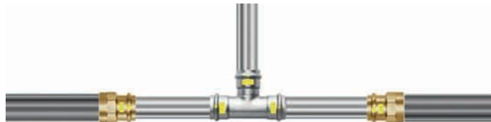
Modification sur une installation existante en acier galvanisé
