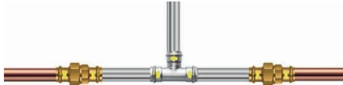
Modification sur une installation existante en cuivre
