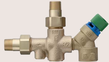
1325 Sicherheitsgruppe mit Rohrverschrau- bungen, bestehend aus Rückflussver- hinderer und Sicherheitsventil, für Wassererwärmer bis 90 °C, 6 bar fest- eingestellt
