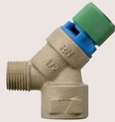
1301 Membran-Sicherheitsventil für Wasser- erwärmer bis 90 °C, 6 bar festeingestellt
