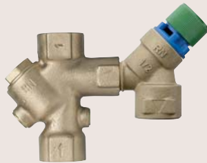
1320 Sicherheitsgarnitur, bestehend aus Rückflussverhinderer und Sicherheits- ventil, für Wassererwärmer bis 90 °C, 6 bar festeingestellt
