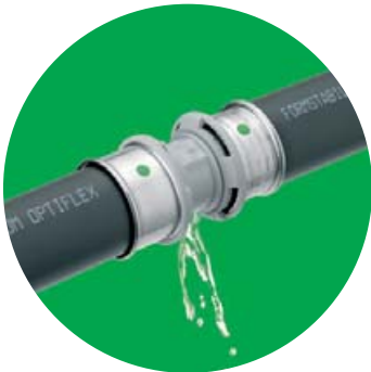
SC-Contour unverpresst: sichtbar undicht SC-Contour non serti: visibilmente non étanche SC-Contour non pressato: la mancata tenuta è visibile
