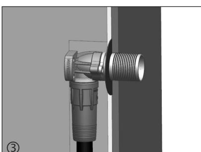
Nachdem die Optiflex-Dose eingemauert ist, wird die Dichtscheibe 85124.22 über die Abdichtungsverlängerung geschoben.
