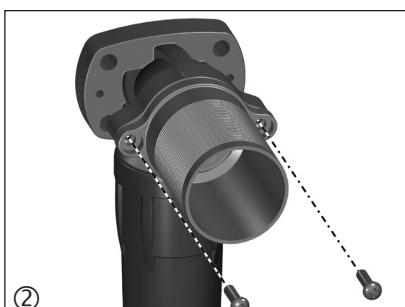
Abdichtungsverlängerung auf die Optiflex-Dose auflegen und mit den Linsenkopfschrauben an der Optiflex-Dose befestigen.
